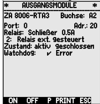
Alte Ausgangskabel lassen sich mit der AMR-Control auf die V6-Funktionalität umkonfigurieren. Die Module sind an beide Ausgangsbuchsen A1 und A2 (3) ansteckbar. Um alle Elemente ansprechen zu können, wurden jeder Buchse 10 Portadressen zugeordnet:
