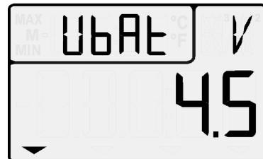
Im Anschluss sehen Sie im Hauptfeld den Messwert mit Dimension, im Funktionsfeld wird die Messstelle angezeigt. Alle möglichen besonderen Betriebszustände des Messwertes werden in 9.1 erläutert.
