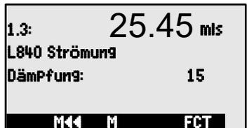
der Funktion **Dämpfung** über die Anzahl der jeweils gemittelten Werte im Bereich von 0 bis 99 einstellbar. Der beruhigte Messwert gilt auch für alle folgenden Auswertefunktionen und ist somit auch in Kombination mit der Mittelwertbildung über einzelne Messwerte (s. 14.2.2) einsetzbar.
