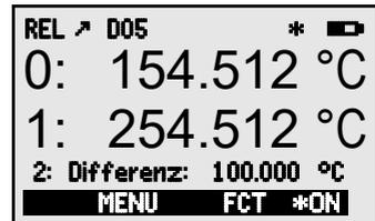
Zusätzliche Messfunktionen sind im Funktionsmenü (s. 11) realisiert und können mit Taste **<FCT>** angewählt werden.
