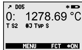
An das Messgerät ALMEMO® 1020 sind 4 verschiedene genaue und stabile Thermoelemente vom Typ N, S, R und B anschließbar. Die Auflösung beträgt bei allen 0.01K. Die Messbereiche und die Bereichskürzel sehen Sie in der folgenden Tabelle, sowie Befehle zur Programmierung entsprechender Fühler oder Stecker über Terminal (s. Hb. 6.3.3).
