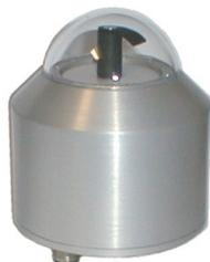
Globalstrahlungs-Messkopf FLA613GS-SDEK, Messung der globalen, direkten und diffusen Sonnenstrahlung (eingebauter Schattenbügel), spektrale Empfindlichkeit 380 nm bis 1100 nm.
